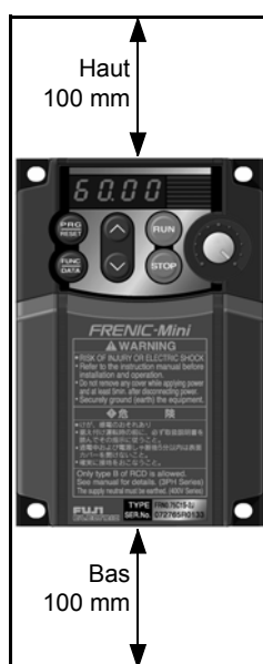
Figure 2-2-1 Sens de montage et distances nécessaires
