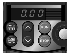
Figure 4-1-2 Afficheur LED après la mise sous tension
