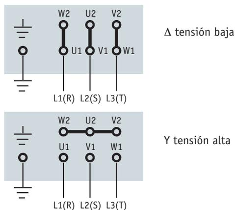
Para arrancadores estrella-triángulo, suaves u otros, atenerse a los esquemas del fabricante de cada equipo.
